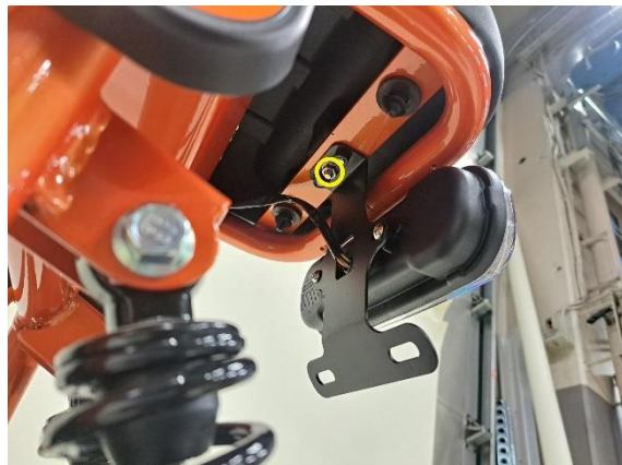
Irrota istuimen kiinnitysmutteri (kiintoavain 10 mm).
