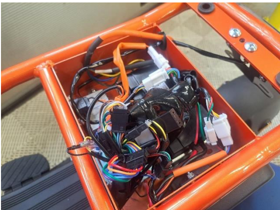
Ota kaikki liittimet esille ja asenna uusi johtosarja liitin kerrallaan paikalleen.
